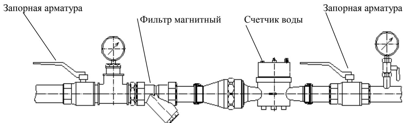
**Пример пломбирования узла учета**
